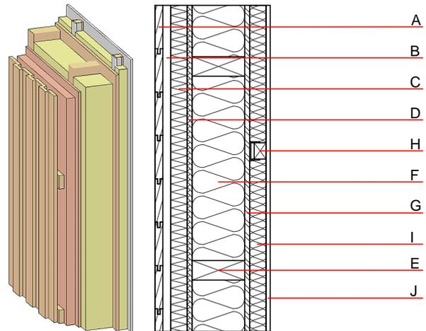
Bemerkung: Je nach Lattungsanordnung auch belüftet/ hinterlüftet möglich e=625
