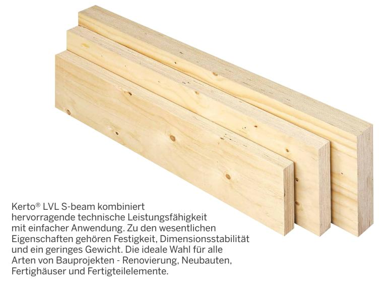
Kerto LVL S-beam wird aus 3 mm starken, festigkeitssortierten Nadelholzfurnieren hergestellt. Die Faserrichtung ist bei allen Furnieren gleich. Die Furniere sind mit einem koch- und wetterfesten Phenol-Formaldehyd-Klebstoff verbunden.
