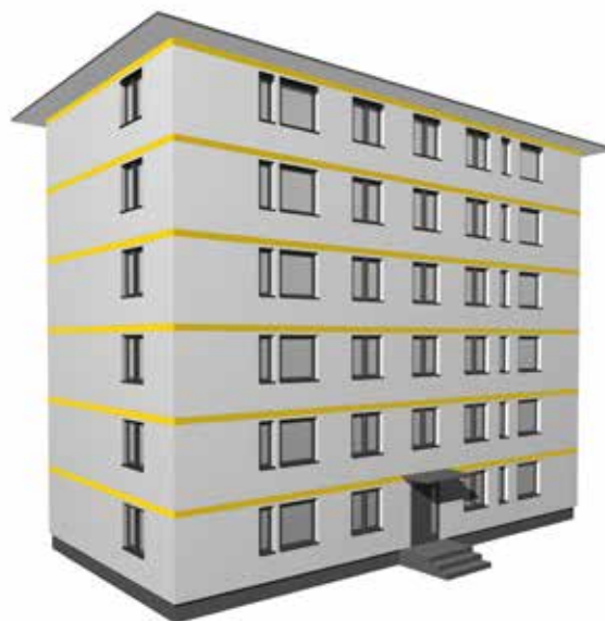
Umlaufende Brandschutzbänderolen bei einem mehrgeschoßigen Gebäude.
